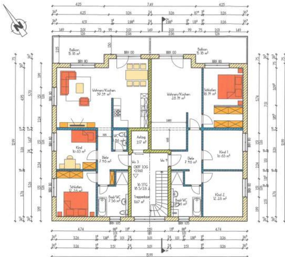
Auszug Grundriss 1. Obergeschoss zum Bauantrag
