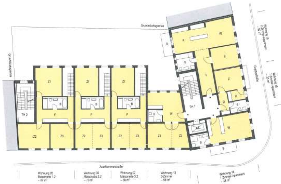
Auszug Grundriss 2. Obergeschoss zur Bauvoranfrage
