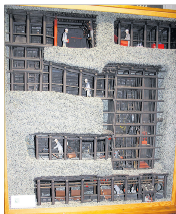
Das Modell „Erzgebirgischer Firnenstoßbergbau“ stellt die Arbeitsbedingungen und die Abbautechnologie im ehemaligen Bergbaubetrieb Aue der SDAG Wismut.
