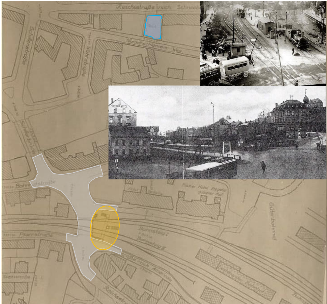
Abbildung 4 Lageplan des Baubereiches mit dem schienengleichen Übergang der Lößnitzer Straße vor Bau der Bahnhofsbücke und Bilder des Bahnüberganges zum Vergleich
